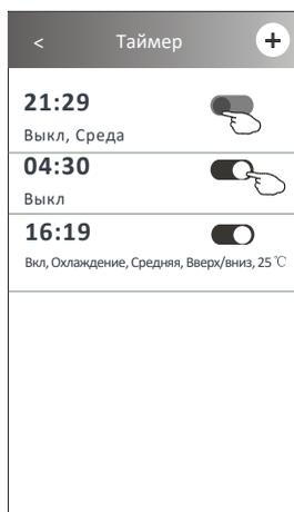
Установите переключатель слева, чтобы выключить таймер.
