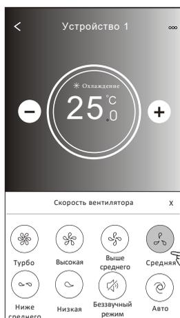
**Заметка:** Скорость вентилятора нельзя регулировать в режиме осушения.
